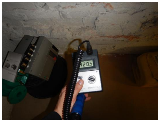
Kuvat 5 ja 6. Kosteuspoikkeama IV-konehuoneen ja kattilahuoneen maanvastaisten seinien alaosissa.
