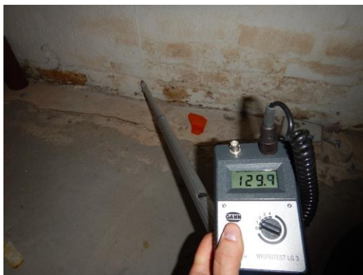
Kuvat 5 ja 6. Kosteuspoikkeama IV-konehuoneen ja kattilahuoneen maanvastaisten seinien alaosissa.
