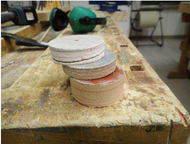
Kuva 17. RA5. Lattian pintakerrokset.
