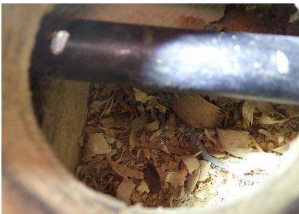
Kuva 15. RA3. Materiaalinäyte M3 otettiin kutterinpurueristeestä. Näytteessä ei havaittu vaurioon viittaavia mikrobeja.
